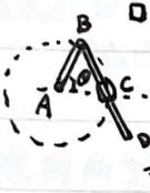
B 铰接，AB 杆长  $r$  绕 A 匀速  $\omega$  转。位置用  $\theta$ 。
